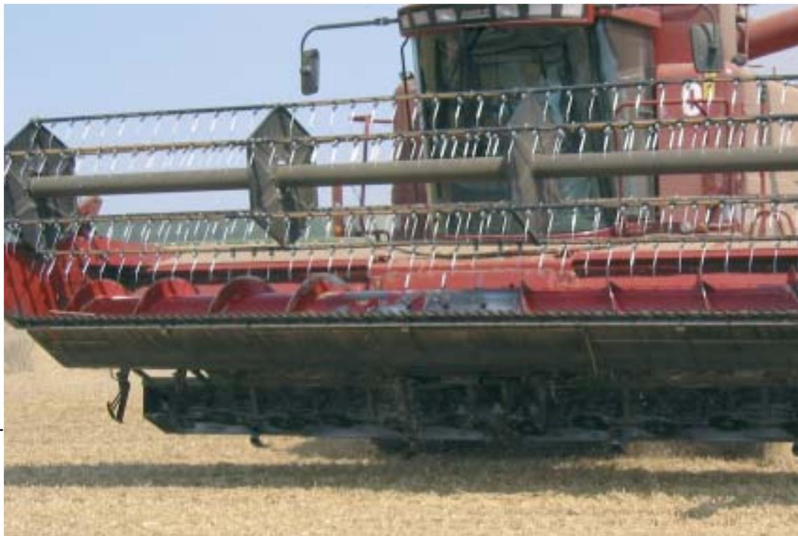
**Le broyeur, entre la barre de coupe et les roues avant de la moissonneuse, travaille à 5 cm du sol pendant que la coupe moissonne les épis.**
