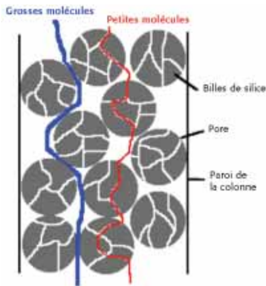
Chemin des protéines dans la colonne remplie de billes de silice poreuses
