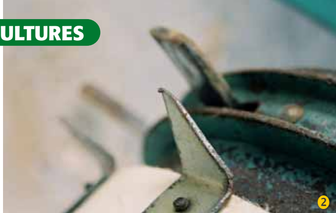
Les picots doivent être régulièrement limés pour ne pas déranger la nappe de lin.
