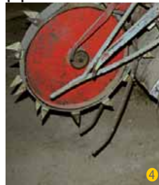
Les fers de guidage en sortie de l'arracheuse ou de la retourneuse doivent être vérifiés souvent, au risque de créer rapidement des paquets.
