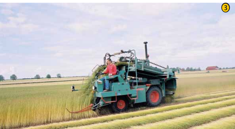
Une arracheuse bien réglée déposera une nappe homogène et bien alignée.
