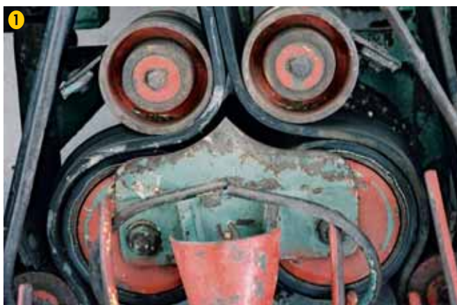
Les cœurs de l'arracheuse doivent permettre un passage fluide du lin.
