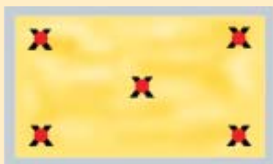
Répartition des points de prélèvement de grains dans une case de ventilation séchante (source ARVALIS - Institut du végétal)
