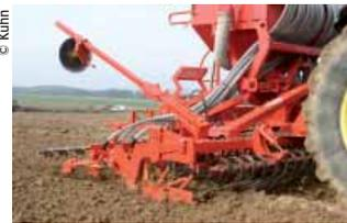
Les lames cross board permettent d'émettre et d'améliorer le nivellement à vitesse élevée. ▲
