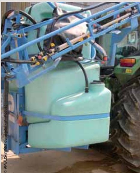
Une cuve de rinçage doit avoir un volume adapté à la cuve principale pour assurer les différentes dilutions de rinçage.
