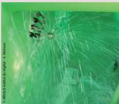
Une buse de rinçage interne, ou rotobuse, permet d'assurer un rinçage complet de la cuve.
