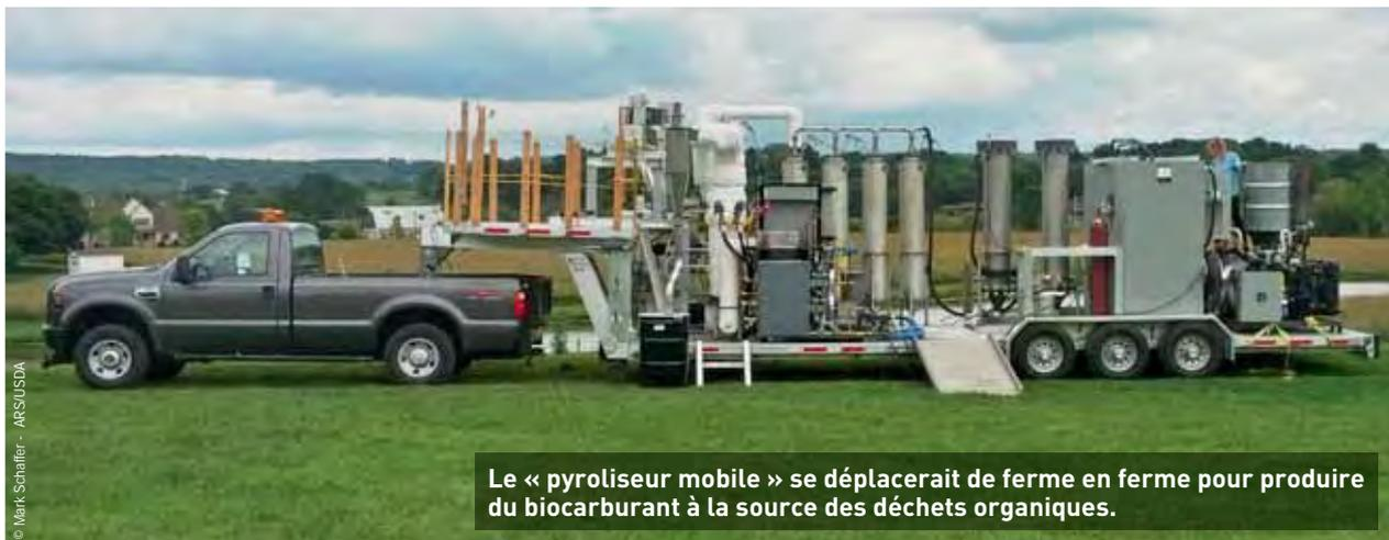
Le « pyrolyseur mobile » se déplacerait de ferme en ferme pour produire du biocarburant à la source des déchets organiques.
