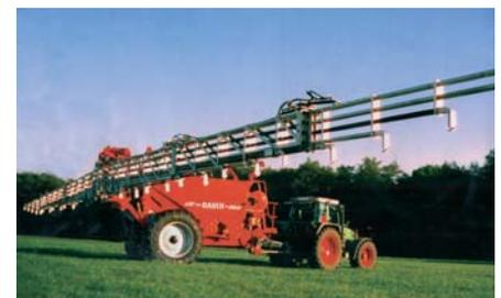
**L**a société **Rauch** relance le distributeur pneumatique avec un appareil traîné de 6000 litres équipé d'une rampe de 36 mètres montée sur parallélogramme avec correcteur de dévers. Les 6 tronçons avec réglages séparés et régulation de la dose, sont animés par un moteur hydraulique à régulation tachymétrique. Les commandes sont facilitées grâce à une poignée multi-fonctions ergonomique. ■
