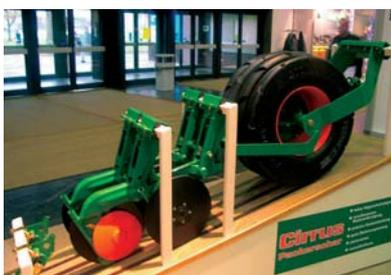
principe cher à Amazone de préparer le sol devant les éléments semeurs, le Cirrus est équipé à l'avant de sa rampe de semis à disques, d'un nouveau rouleau à revêtement en caoutchouc dur. ■
