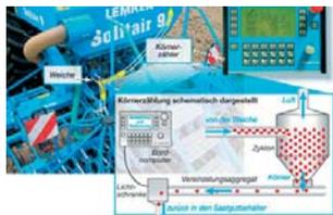
Parmi les autres innovations, Lemken propose aussi un système permettant d'ajuster automatiquement et précisément la dose de
