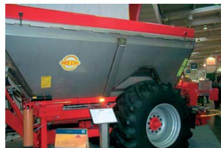
Distributeur traîné Bredal ; Alimentation des disques par tapis, ouverture de la bêche de trémie hydraulique
