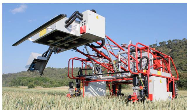
*La phénoMobile est un robot bardé de capteurs qui « scannent » les cultures. Les réactions des plantes aux conditions climatiques sont analysées finement et permettent de repérer variétés et pratiques culturales les mieux adaptées aux changements.*
