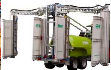
WEBER – descentes avec panneaux récupérateurs
